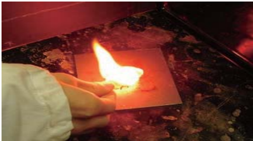
図3 炎色反応付きニトロセルロースの燃焼の様子 (上が銅、下がストロンチウム)
