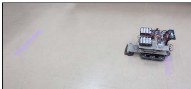
図 19 マウスを取り付けて、100cm 走ったら 停止させる実験の様子
