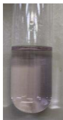
写真 2. 塩化鉄(III)の呈色反応(改良後)
