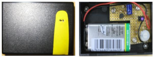
実験方法：数ある変調の中でも今回は慢性的にも瞬間的にもストレスの影響を受けていると思われる血液量の変化からアプローチをかけた。ではどうやって測るのか。実は血液量の変化を測る機械は製品化されている。だが、それは高価で大型であるため、指先で血液量を測る脈波計を自作した(右図参照)。この脈波計をデータロガーによってパソコンに血流量をデータとして取り込んだ。データロガーは、血液によって吸収される赤外線の量を波として表すためその変化がリアルタイムで表示される。この自作機械を使って次の実験を行った。この実験では精神的なストレスに限定し、比較的自覚しやすい「焦り」を見るため「一分間に『さ』つく言葉を20個書きなさい」というタスクをかけた。
